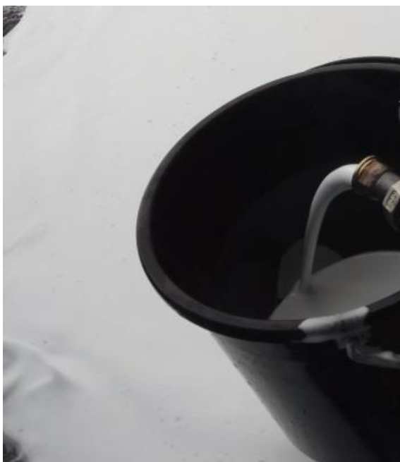
Рисунок 2.3 – Отбор пены из отвода подводящего трубопровода до выхода экспериментальной установки на рабочий режим
